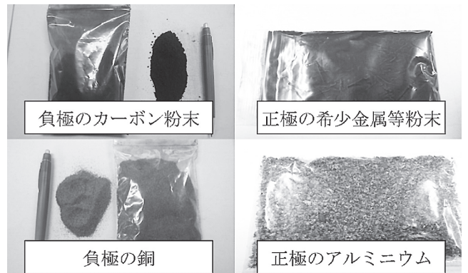
写真6 LIB電極材を破碎・選別した粉末
