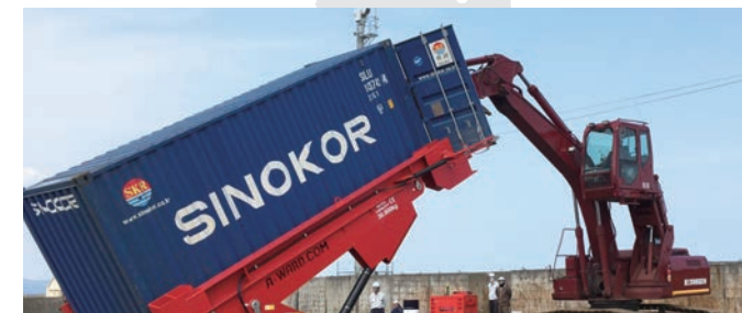
コンテナに鉄スクラップを入れている様子
