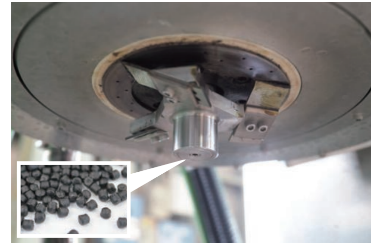
再生樹脂ペレットの製造
